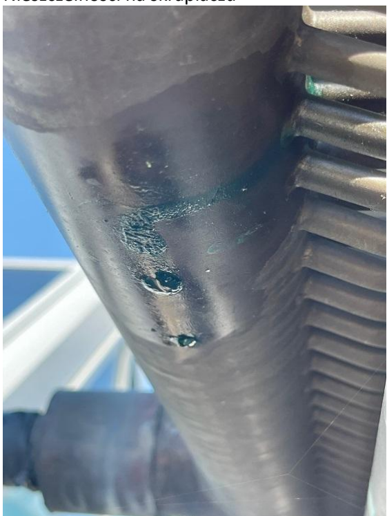
Nieszczelności na skraplaczu
