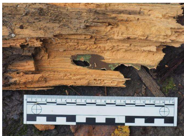
Fot. 39. Fragment ościeżnicy drzwi zniszczony przez owady ksylofagiczne i grzyby domowe.
