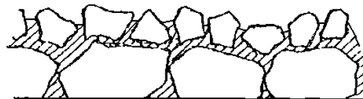
Rys. 3. Schematyczny obraz powierzchniowego utwardzenia nawierzchni typu „sandwich”
