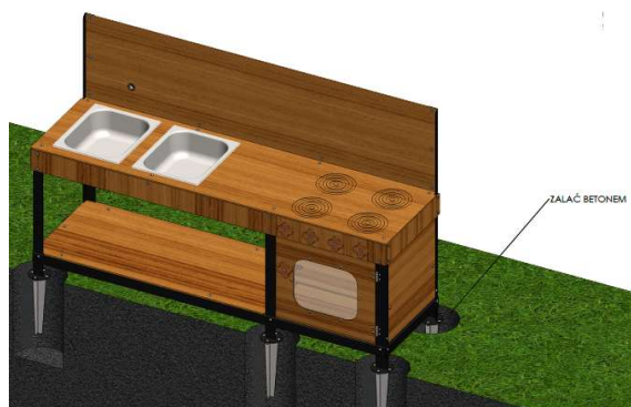
Rys. Schemat fundamentowania kotew
