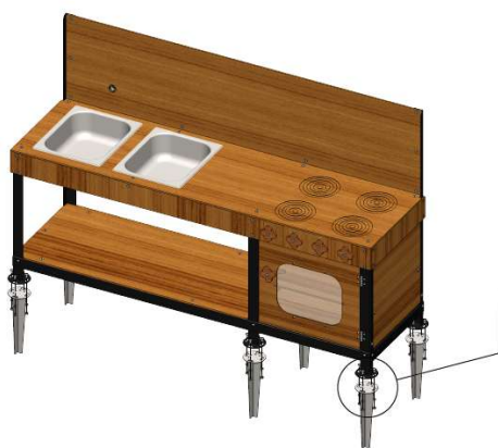
Rys. Schemat montażu kotew
