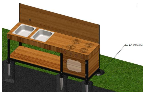
Rys. Schemat fundamentowania kotew
